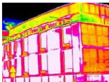
Wärmeverlust: Das Foto wurde mit einem wärmempfindlichen Film aufgenommen. Die weißen Flächen zeigen, an welchen Stellen das Gebäude Wärme verliert. Foto: dpa
